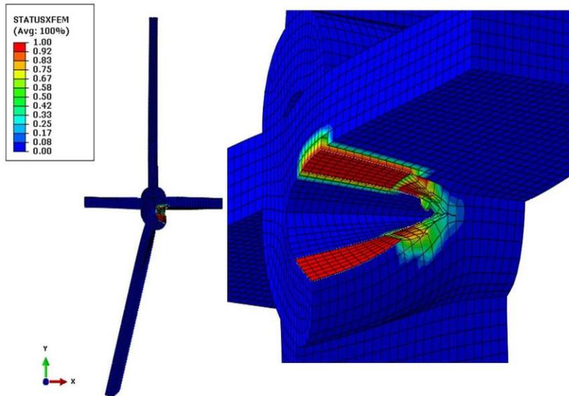
(d) Crack propagation at step 16
