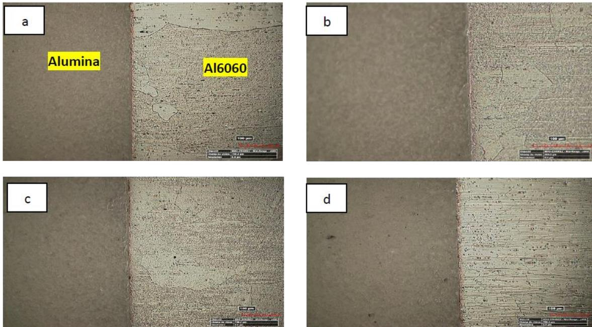
Figure 5. Microstructures of bonded alumina/Al 6060 alloy at 600°C for different bonding times (a) 2 min, (b) 3 min, (c) 4 min, and (d) 5 min
