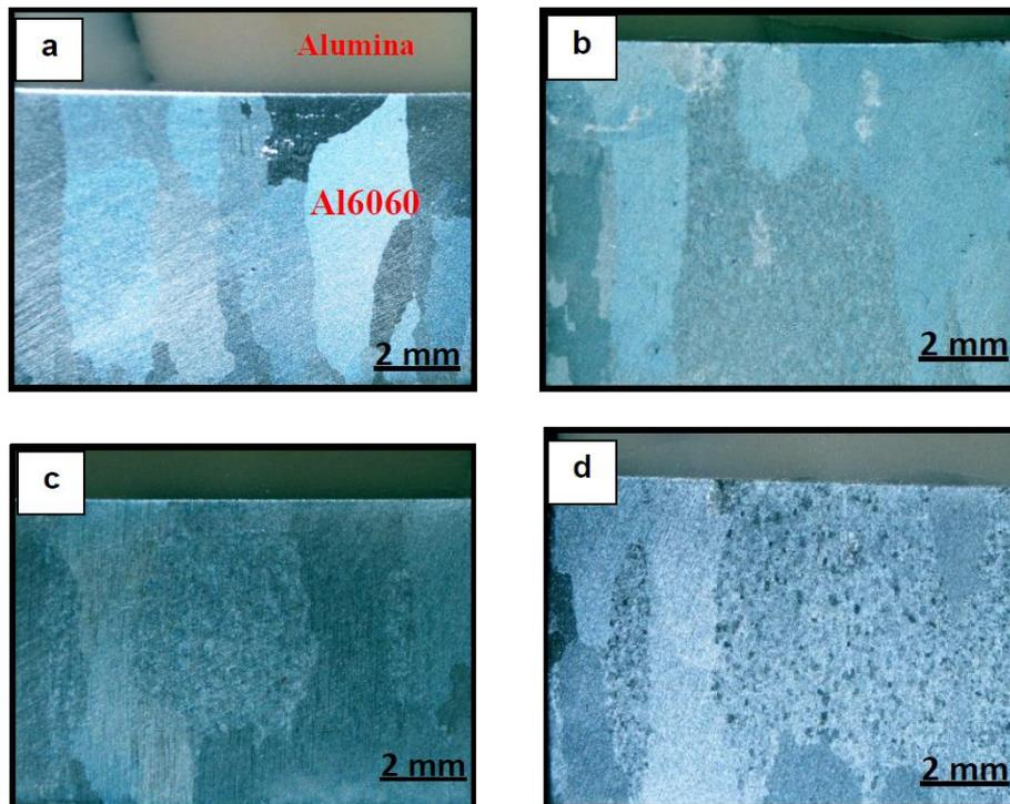
Figure 4. Macrostructures of bonded alumina/Al 6060 alloy at 600°C for different bonding times (a) 2 min, (b) 3 min, (c) 4 min, and (d) 5 min
