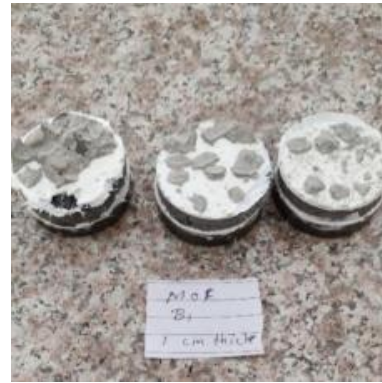
(d) Separation of the NSC surface without adhesive de-bonding
